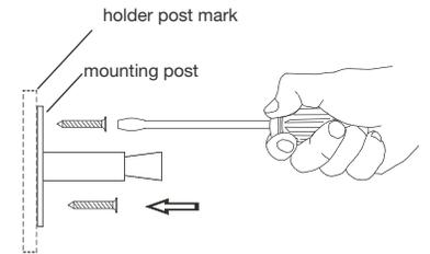
**INSTALLING ONTO DRYWALL SURFACE**
